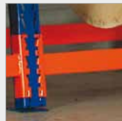
Querverbinder als Feldaussteifung; verschiedene Längen je nach gewünschter Feldbreite
