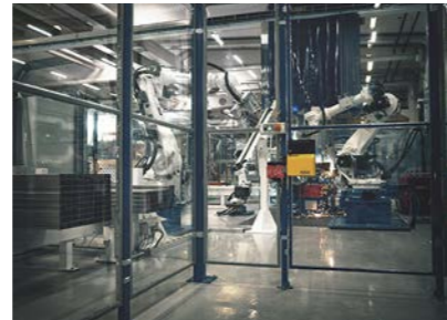
POLYCARBONAT ELEMENTE Ermöglichen optimale Transparenz und Schutz bei Schweiß- und Schneidwerkzeugen sowie gefährlichen Flüssigkeiten.
